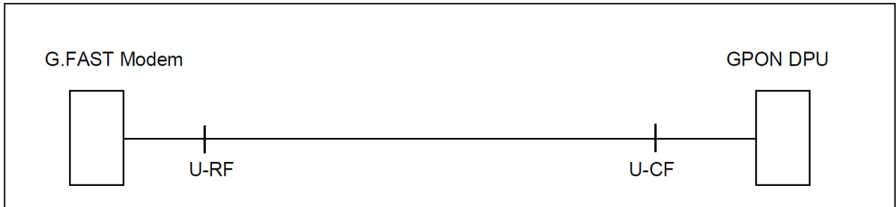
Abbildung Schematische Darstellung eines G.FAST FTTB Anschluss
